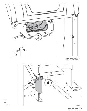
Fig.51 Removing the fan
