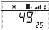
26. Visualização termóstato de segurança com plaqueta ZONA MIX 2 (Entrada S1) respectivamente ON e OFF
