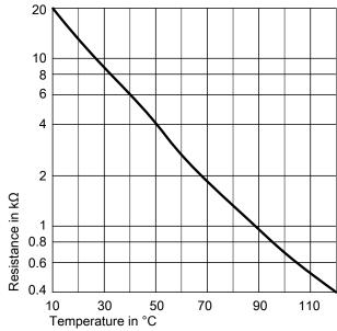
Fig. 51 Sensor type: NTC 10  $k\Omega$
