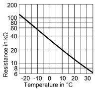
Fig. 44 Sensor type: NTC 10  $k\Omega$
